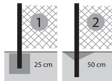
Nel primo caso (fig. a sinistra) è previsto un muretto o un cubo di cemento in cui fissare il paletto. Di conseguenza occorrerà scegliere un paletto di altezza "h + 25 cm";
